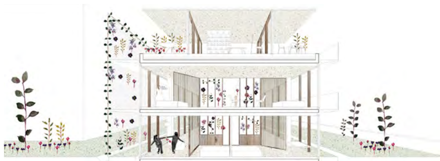
DELITEV BIVALNIH ENOT S POLKARBONATNIMI PLOŠČAMI
